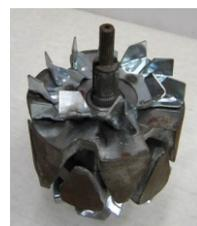
Одновременная сварка 2-х крыльчаток (оцинкованная сталь, 12 рельефов) к ротору генератора новой модели ВА3
