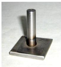
T - образная сварка (титановый стержень к нержавеющей стали)
