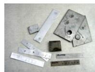
Образцы точечной сварки различных материалов
