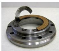
Контактная сварка биметаллических фрикционных колец для катков промышленных тракторов
